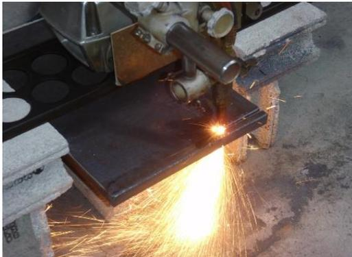
水素酸素ガスにて t 20mm 切断中
