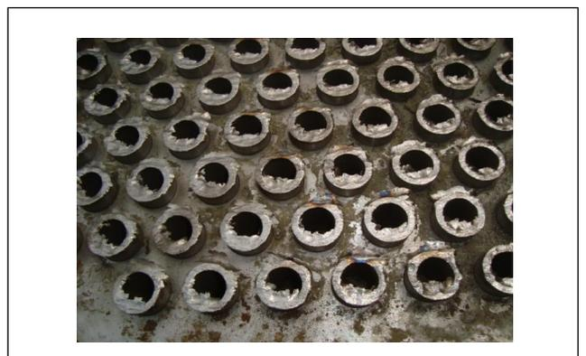
切断面にバリが出て、引きちぎったようになっているのは、本熱交換器の材質が硬くて、ねばい為。
