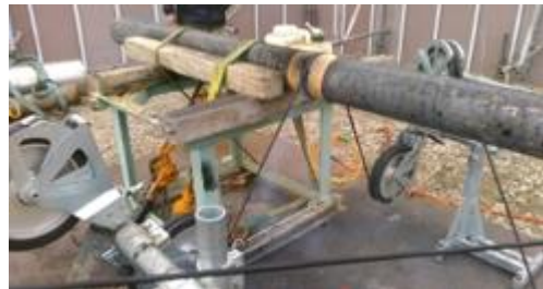
切断中（ワイヤー送り速度： 7\text{m/s} ）
